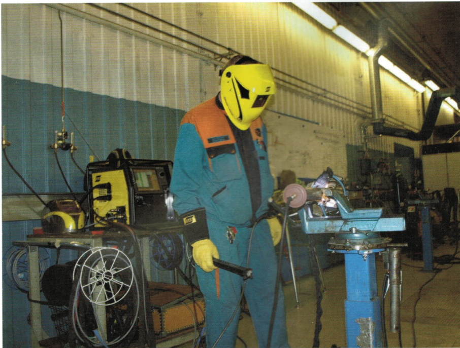
Putkien orbitaali-TIG-hitsaus helpottaa hitsaajan työtä
