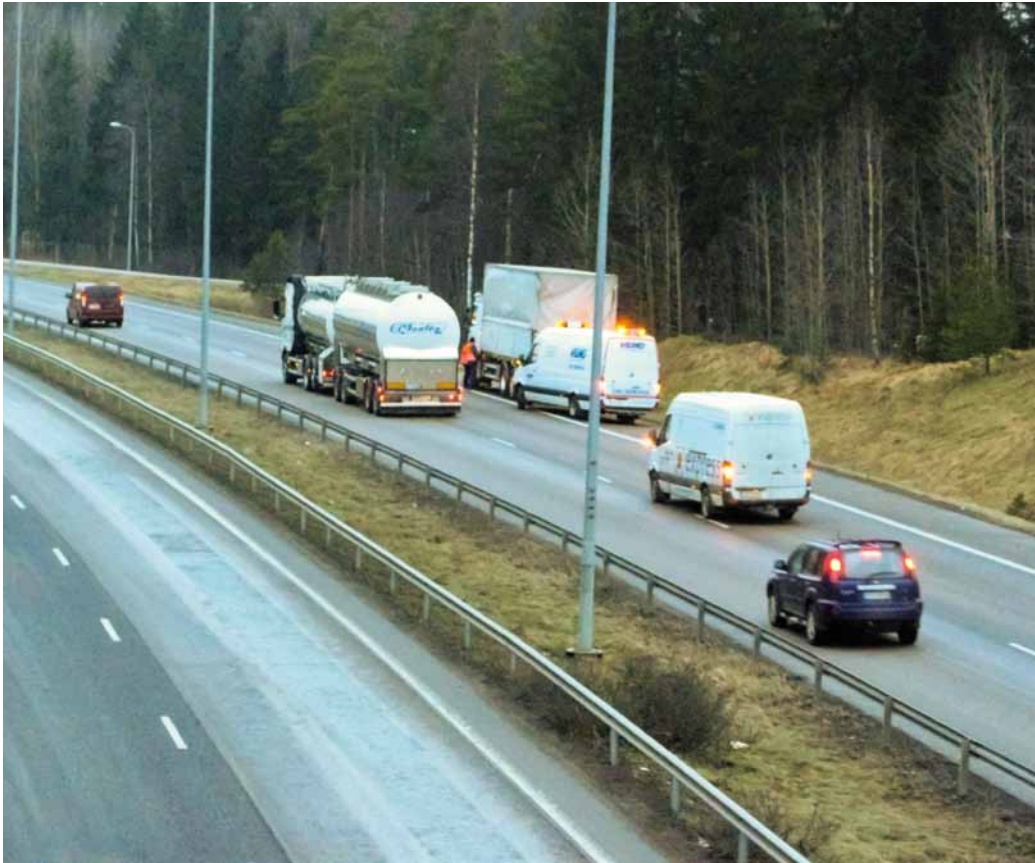
Huoltoauton sijoittelulla on merkitystä sekä auton näkyvyyteen että työn turvallisuuteen. Tässä huoltoauto on vinottain ja hieman kaistalla; takavilkkujen lisäksi näkyvät osittain myös etuvilkut, ja lisäksi korjaajat saavat yli puoli metriä lisää työskentelytilaa.
